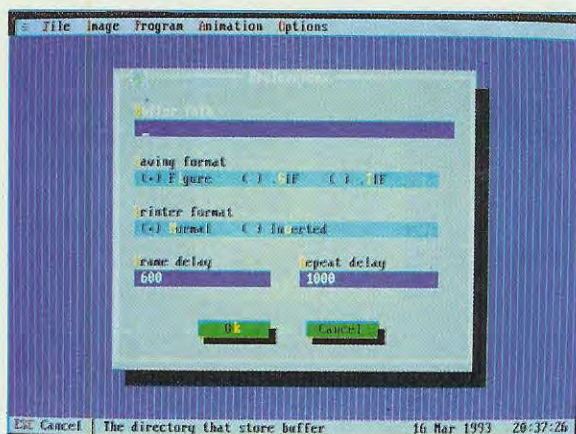
Fig.22 Premendo Alt O e P potrete cambiare la velocità "Frame Delay" e la pausa "Repeat Delay" tra due sequenze.
